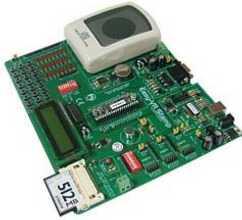
Fig. 3.c : Easy-VR-Stamp tester and programmer
